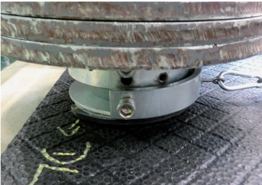
Bild 2: Rutschfestigkeitsmessung nass, mit Barhuf
